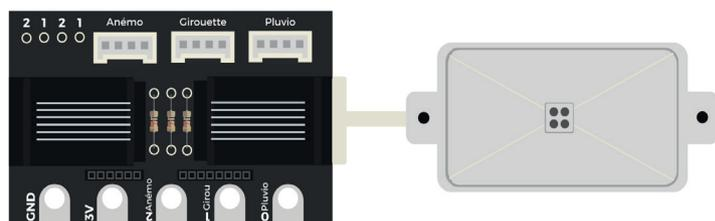
En complément de l'anémomètre ou séparément, vous pouvez ajouter un boîtier pluviomètre. Celui-ci permet la mesure de la quantité d'eau de pluie tombée.
