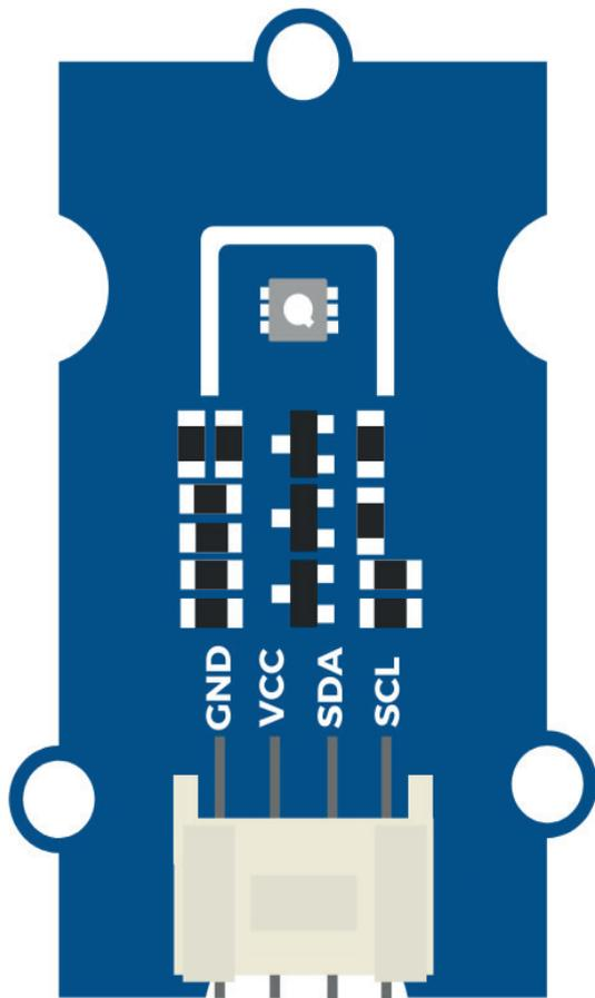
**Capteur de température, de pression et d'humidité Grove**
